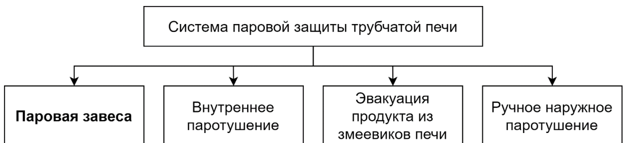
Рисунок 1.5 – Структура системы паровой защиты технологической трубчатой печи
