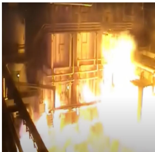
б) Процесс распространения фронта пламени при возгорании облака ТВС
